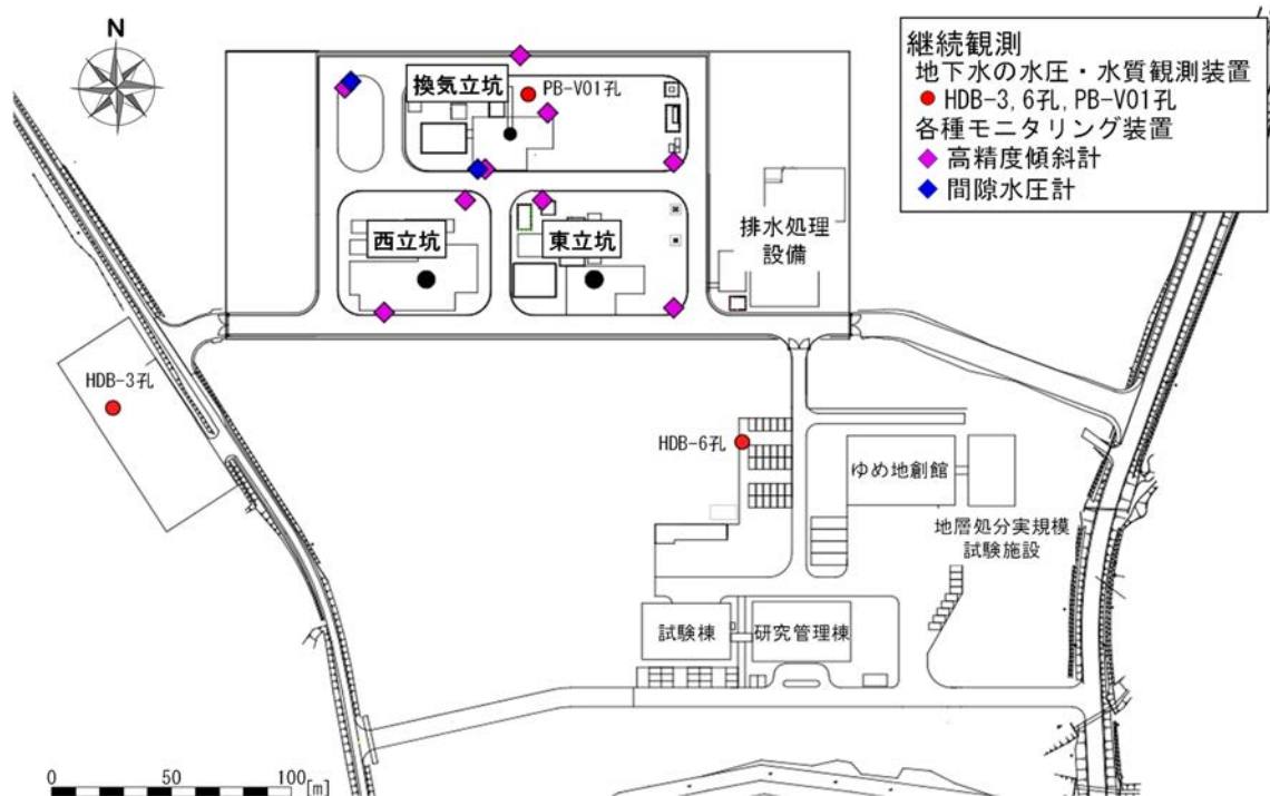
図 3 研究用地における主な施設と観測装置の配置
