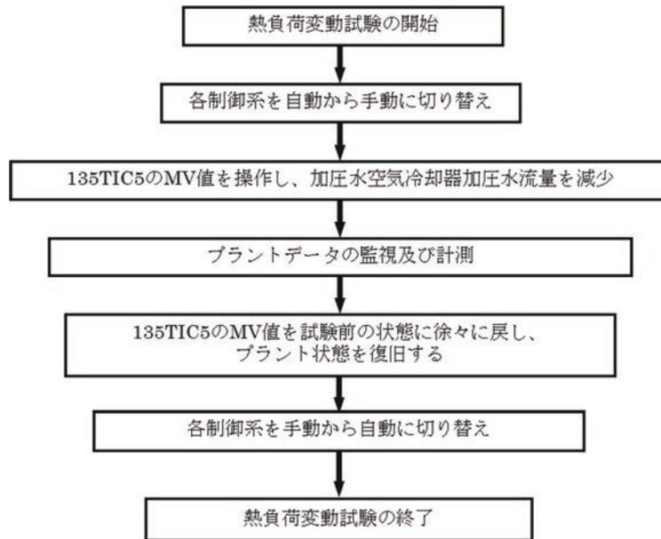
図4.1.5 熱負荷変動試験の試験手順
