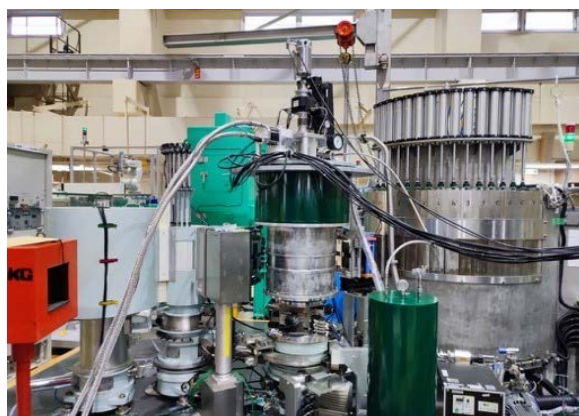
図 1 無冷媒式 10 T 超伝導マグネットを搭載した TAS-2
