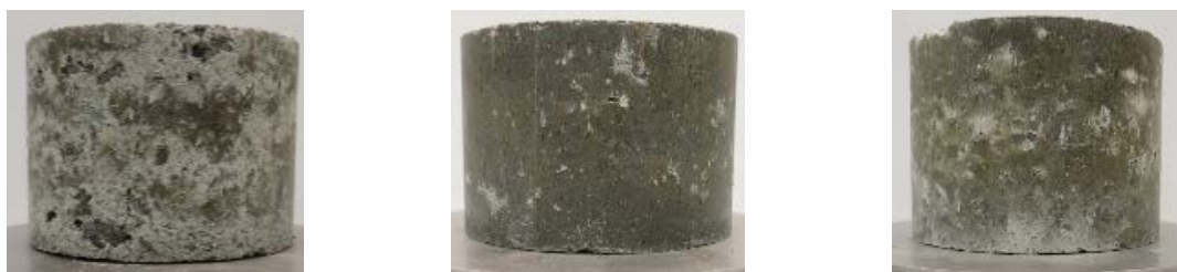
(a) ベントナイト混合率：15% (b) ベントナイト混合率：30% (c) ベントナイト混合率：40% 図46 静的締固め試験後の供試体の外観（成型圧力：20 MPa）
