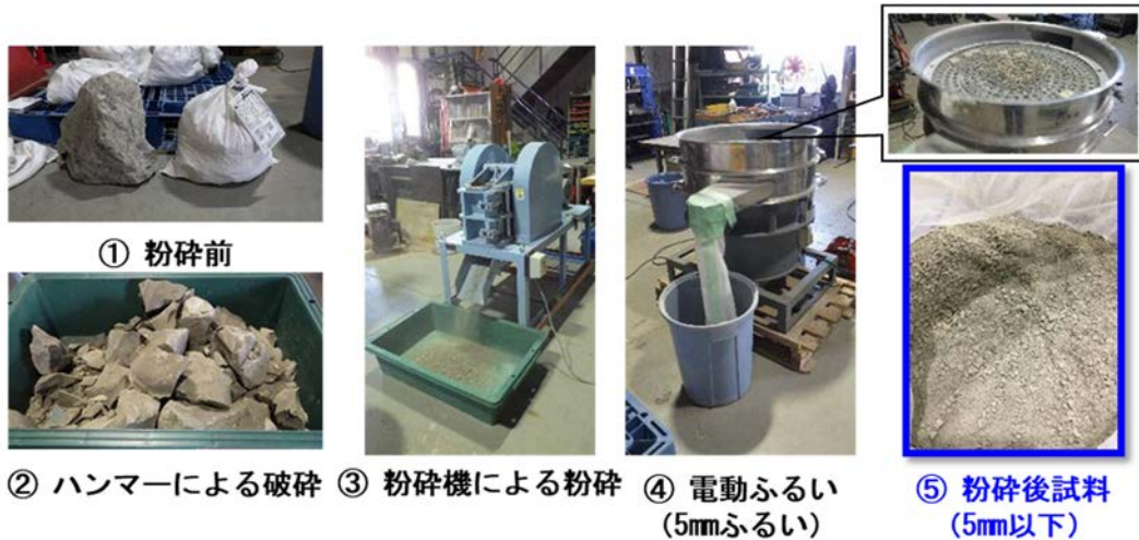
図 34 幌延泥岩（掘削土（ズリ））の粉碎状況
