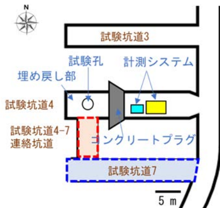
(a) 坑道掘削のイメージ
