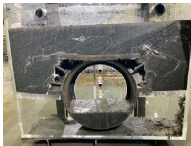
図2 ジオポリマーによる止水・固化体の切断面
