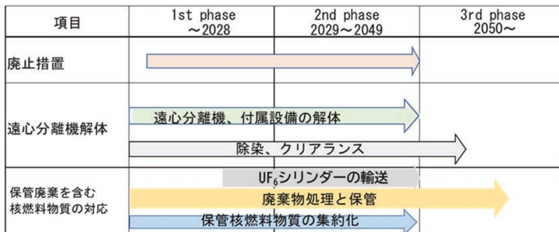
図1 廃止措置及び遠心分離機解体計画概要
