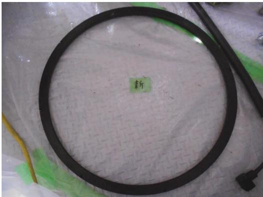
写真 2.1.5 隔離弁シートパッキン
