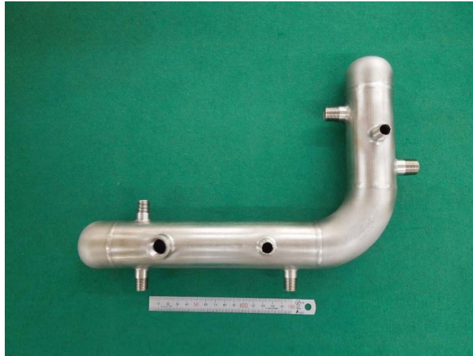
図IV-5-3 JRR-3垂直キャプセル保護管の漏えい試験使用治具
