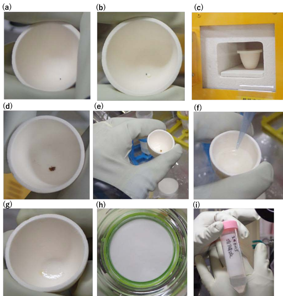
(a) 融解前の試料と \text{Na}_2\text{O}_2 、(b) 融解前の試料と \text{Na}_2\text{O}_2 、(c) るつぼを電気炉に入れた際の様子、 (d) 融解後の生成物、(e), (f) 硝酸溶解の様子、(g) 溶解処理後のるつぼ、(h) ろ過後のろ紙、 (i) 回収した溶解液
