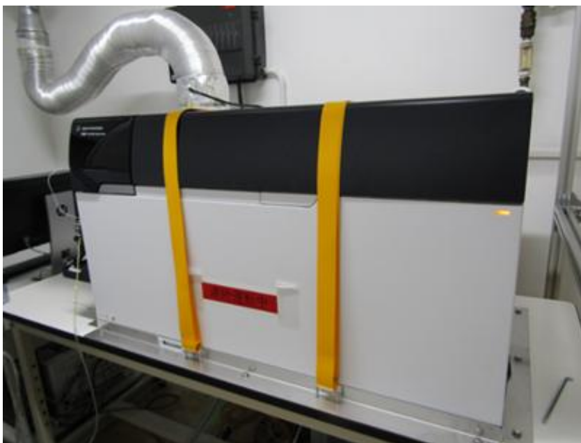
図3. 1. 1-2 整備したICP-MS/MSの外観写真
