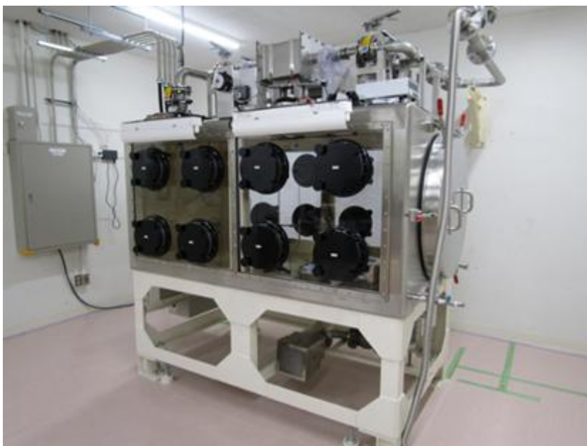
図3. 1. 1-1 整備した試料調製用グローブボックスの外観写真
