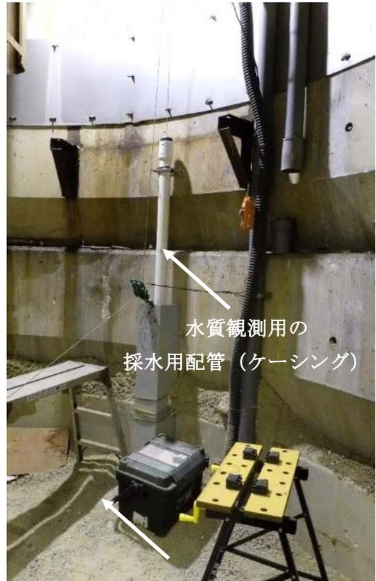
図 2-3 立坑覆工コンクリートに固定されたモニタリングシステム
