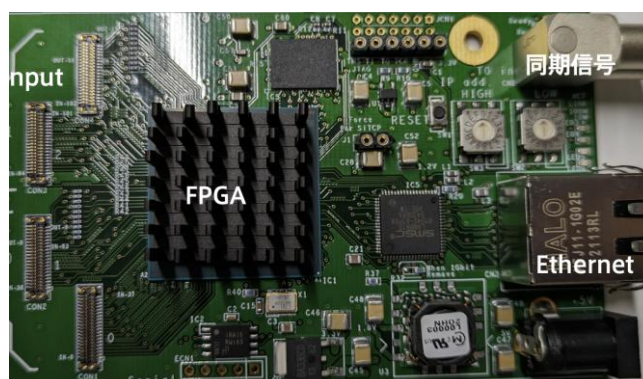
図 3.3-3 FPGA を用いた信号同期型データ取得統合システムの開発
