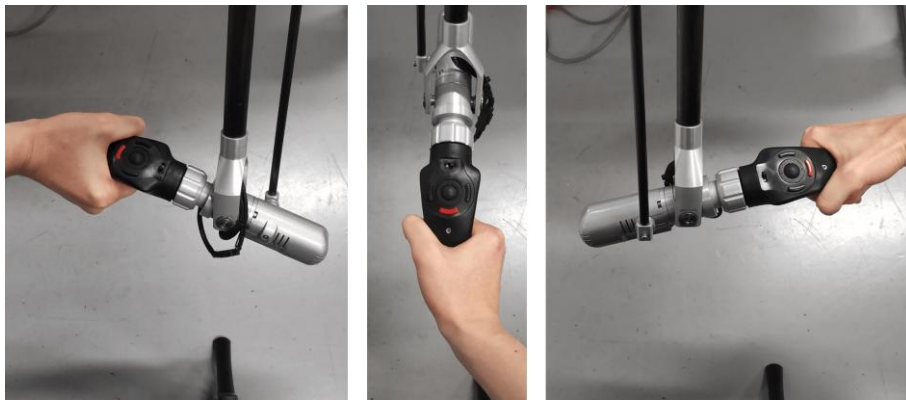
図 3.2.2-8 Haption 社製 6 軸力覚フィードバック装置 virtuose6d35-45 の手先姿勢の動作範囲
