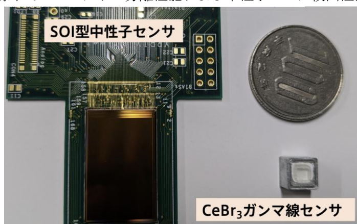
図 3.3-2 \text{CeBr}_3 ガンマ線シンチレータ検出器と SOI 型中性子センサ小型基盤
