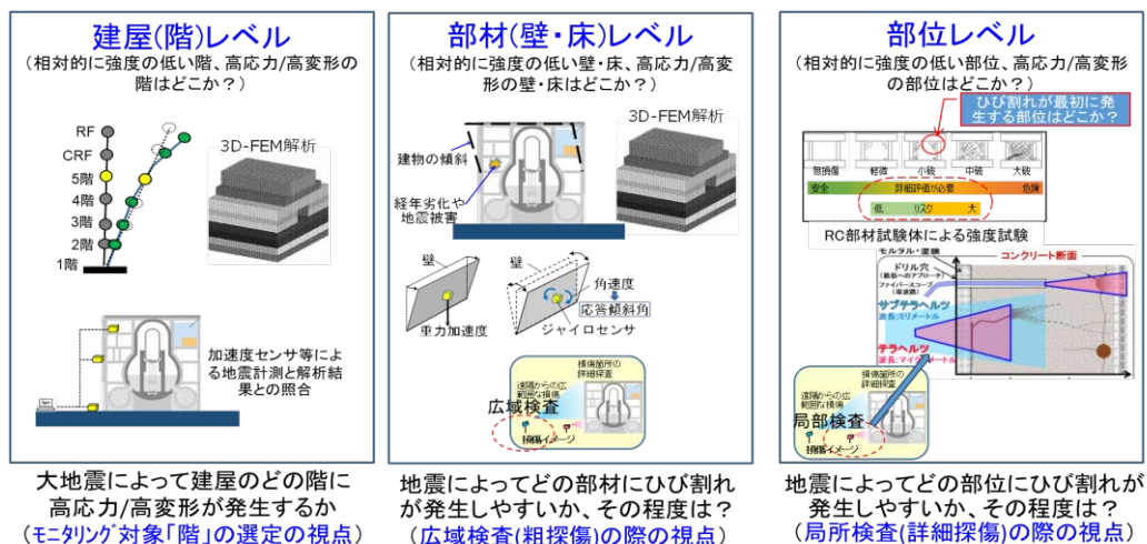
図 3.4-8 建屋の着目すべき箇所と検査・モニタリング方法
