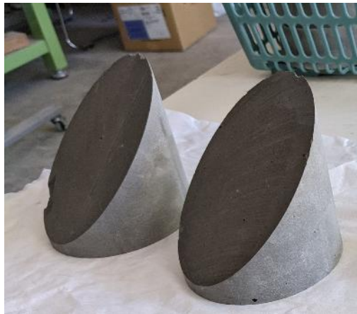
図 3.2.3-3 カットした試験体
