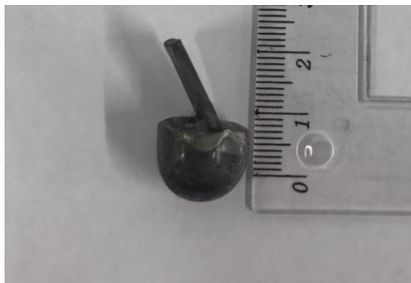
図 3. 2. 2-3 ステンレス鋼とジルカロイを15分加熱した試料の外観
