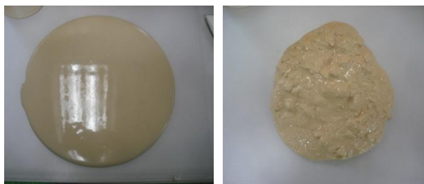
図 3.2.1-15 フロー試験の様子（左：ジオポリマー、右：超重泥水）
