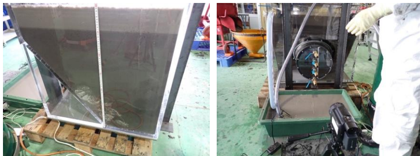
図 3. 2. 1-26 止水試験終了後の試験水槽（左：側面、右：ジェットデフレクター模擬部側）
