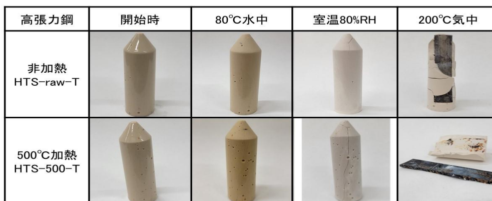
図 3. 2. 4-15 高温保持試験における高張力鋼とジオポリマー複合体の外観
