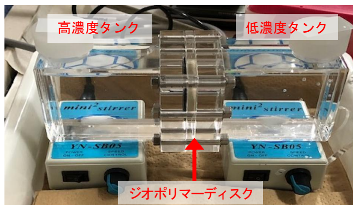
図 3.4-14 透過拡散試験の様子
