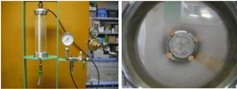
図 3.2.1-18 超重泥水併用試験装置（左図：外観、右図：上面）
