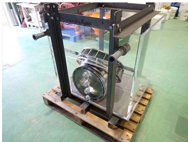
図 3. 2. 1-21 1/6 模擬ジェットデフレクター止水試験水槽
