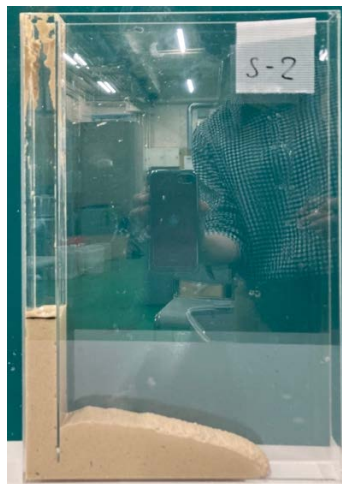
図 3.2.1-4 ジオポリマーが高さ 1 cm の開口を閉塞固化した様子 (No. 4)
