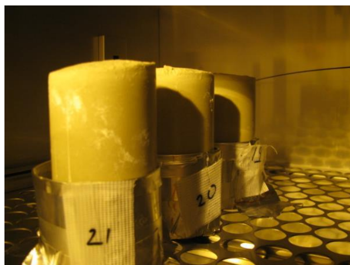
図 3.2.3-2 恒温照射試験状況（恒温・低線量）
