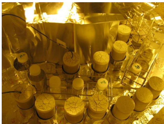
図 3.2.3-5 室温照射試験状況 (奥側から 1 列目と 2 列目に並んだ試料は高線量、 手前の列に並んだ試料は中線量で照射)
