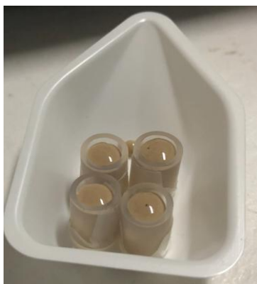
図 3.4-5 PFA 製のチューブ内でのジオポリマー試験体の養生の様子
