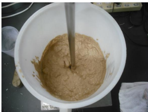
図 3.2.1-14 超重泥水作製状況
