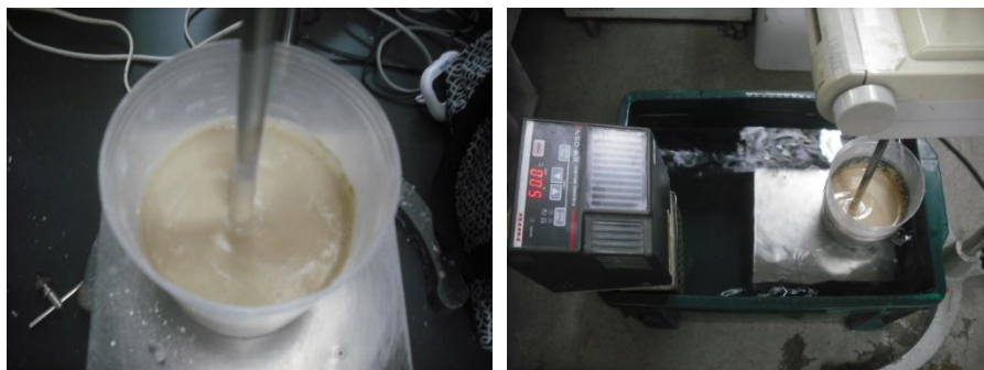
図 3.2.1-13 ジオポリマー作製状況（左図：混練時、右図：加熱時）
