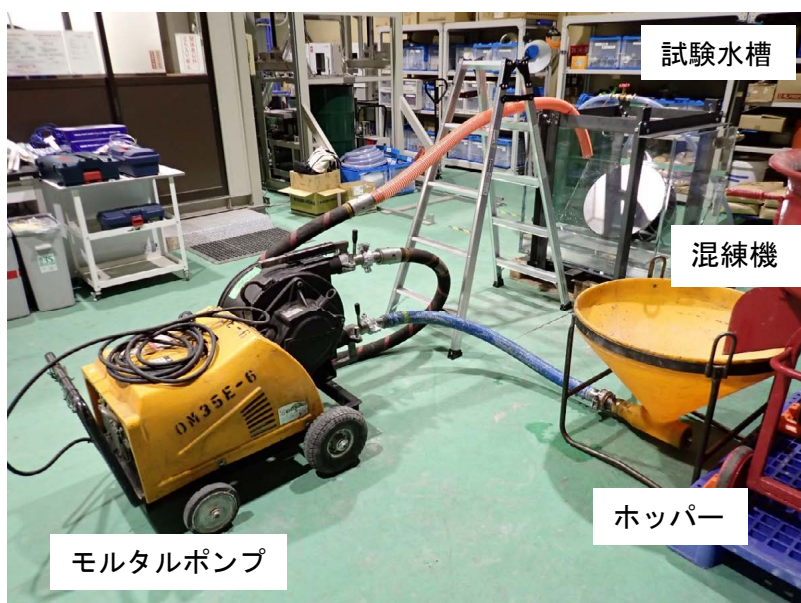
図 3. 2. 1-23 止水試験装置外観
