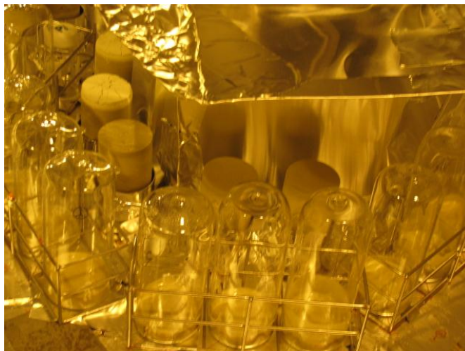
図 3.2.3-4 室温照射試験状況（高線量）
