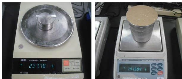
図 3.2.1-16 比重測定の様子（左：ジオポリマー、右：超重泥水）
