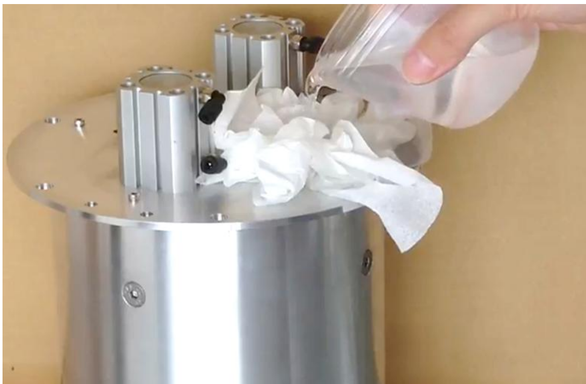
図 3.5-10 CVT-VIA への給油の様子 (製品は出光トラクション油 TDF-1 を 500 [ml]使用)
