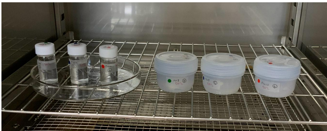
図 3.1.2-8 粉末並びにペレット状での浸出試験の様子（ 50^\circ\text{C} ）
