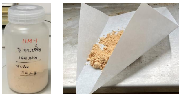
図 3.1.1-2 合成した模擬 ALPS 沈殿系廃棄物リン酸塩
