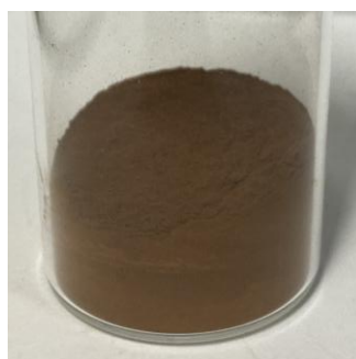
図 3.1.1-4 合成した模擬 AREVA 沈殿系廃棄物
