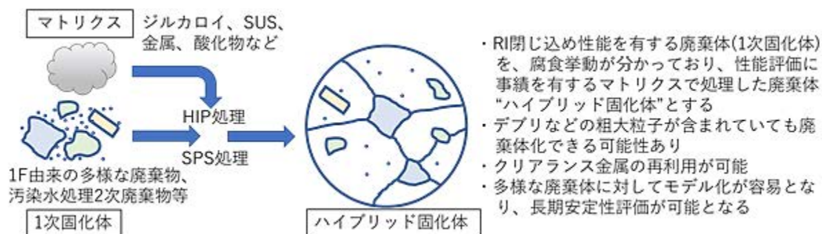
図 1-1 既往の固化体の概念と多様な焼成方法
