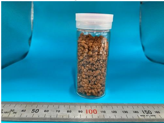
造粒 ALPS 炭酸塩スラリー+造粒鉄共沈スラリー (Run3)
