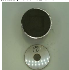
造粒 ALPS 炭酸塩スラリー/還元鉄粉 (Run7、50 cm 3 カプセル)
