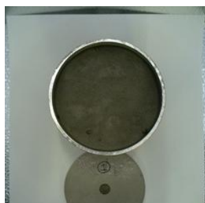
造粒 AgI/SUS304L 粉末 (Run1、500 cm 3 カプセル)
