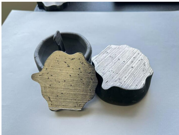
図 3. 4. 1-14 HIP 固化体（造粒ヨウ素アパタイト）の切断断面
