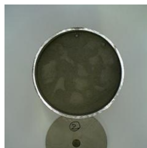
造粒 ヨウ素アパタイト/SUS304L 粉末 (Run2、500 cm 3 カプセル)
