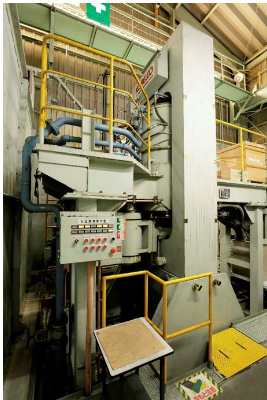
図 3. 4. 1-12 固化処理に用いた HIP 装置と仕様
