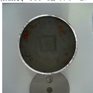
造粒 ALPS 炭酸塩スラリー+造粒鉄共沈スラリー /還元鉄粉 (Run3、500 cm 3 カプセル)
