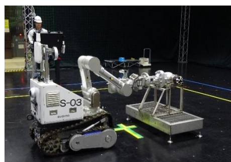
作業用ロボットのバルブ操作訓練
