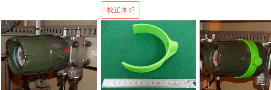
写真 2.4.1-8 校正ネジカバー
