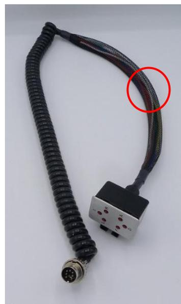
写真 2.4.2-2 マニピュレータ操作スイッチ
