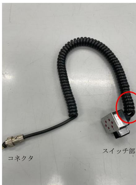
写真 2.4.2-1 マニピュレータ操作スイッチ
