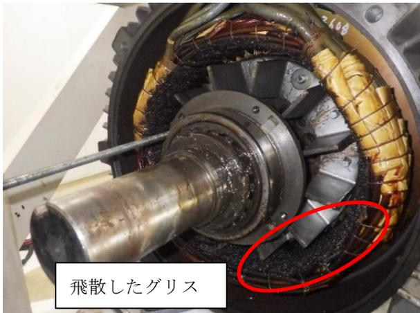
写真 2.2.4-1 グリスの飛散状況(補修前)
