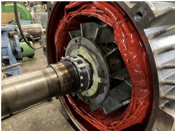
写真 2.2.4-3 洗浄後の巻線(補修後)
