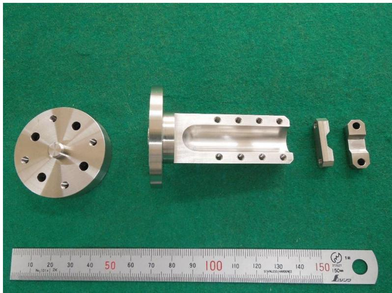
写真 2.4.1-3 電気炉用試料ホルダー
