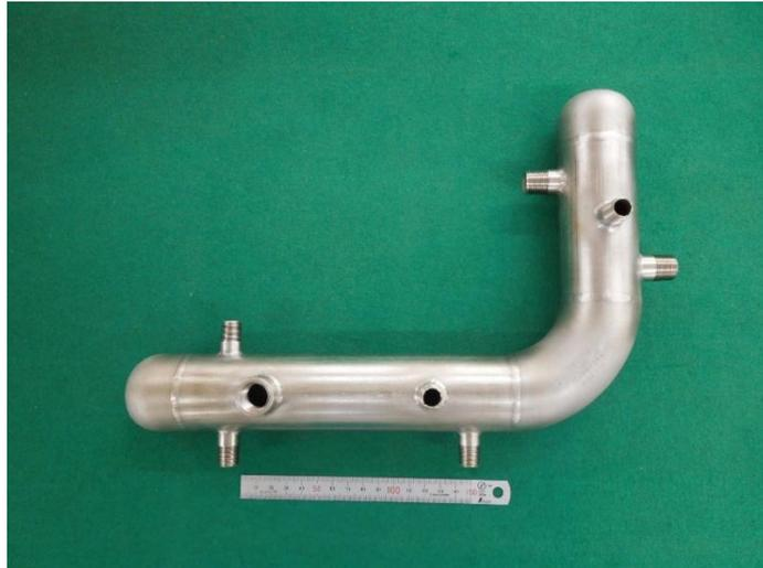
写真 2.4.1-2 JRR-3 垂直キャプセル保護管の漏えい試験使用治具
