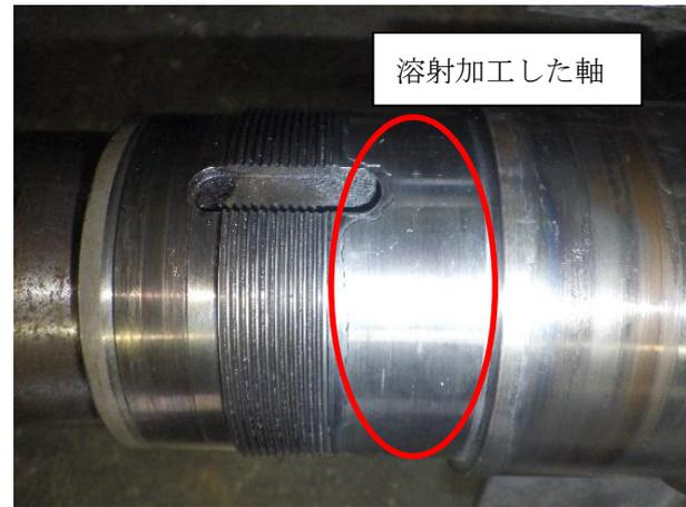
写真 2.2.4-4 溶射加工後の軸(補修後)
