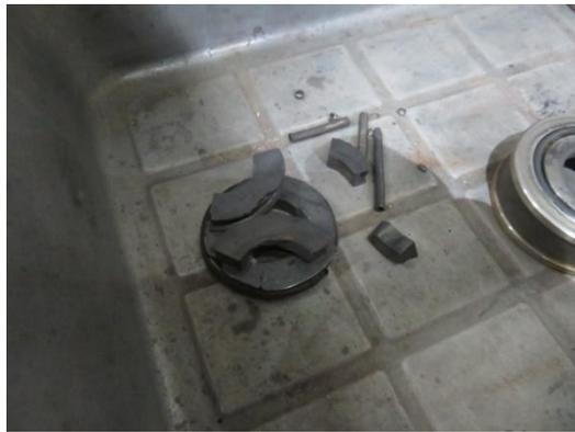
写真 2.2.3-1 ピストンリングの摩耗
