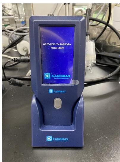
図 3.2-18 光学式パーティクルカウンター (OPC) の外観写真
