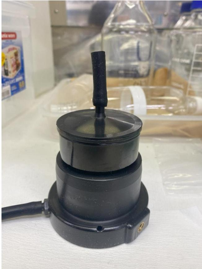
図 3.4-1 肥大化粒子の捕集に用いたインパクトの外観写真
