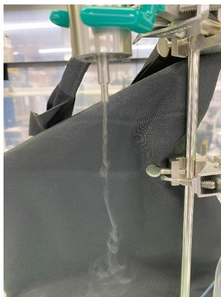
図 3.2-8 超音波スプレーノズルを用いた噴霧の写真
