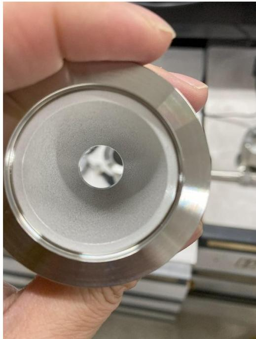
図 3.2-30 乾燥チャンバー(c)のテーパ部に付着した KCl 微粒子の写真
