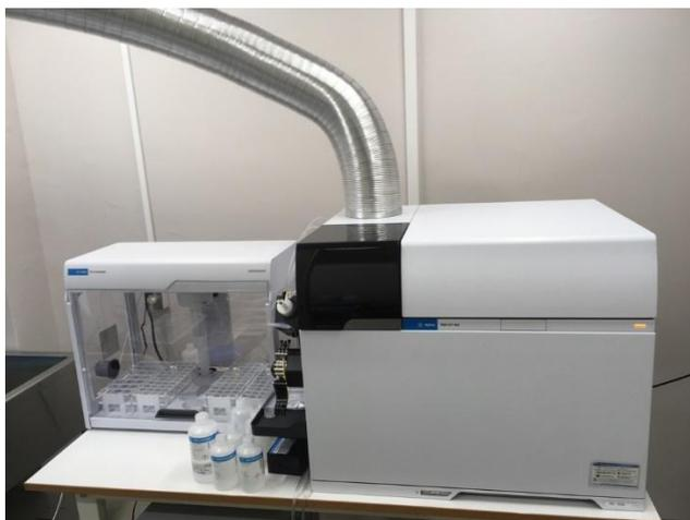
図. 3. 3-3 ICP-MS の外観写真
