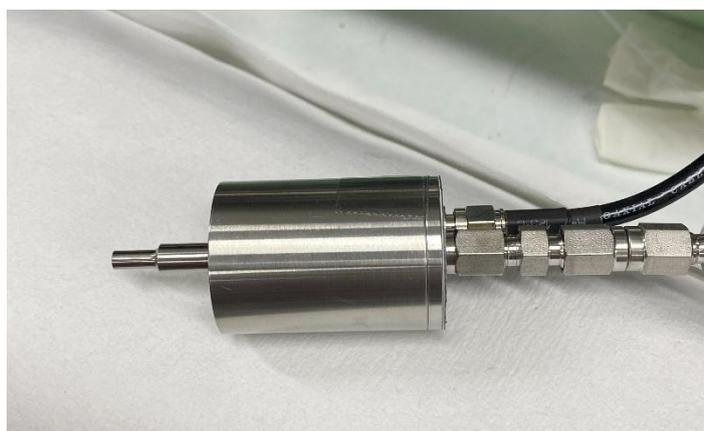
図 3.2-7 超音波スプレーノズルの外観写真
