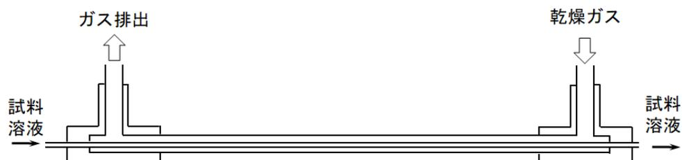
図 3.2-3 MD ガスドライヤーの概略図
