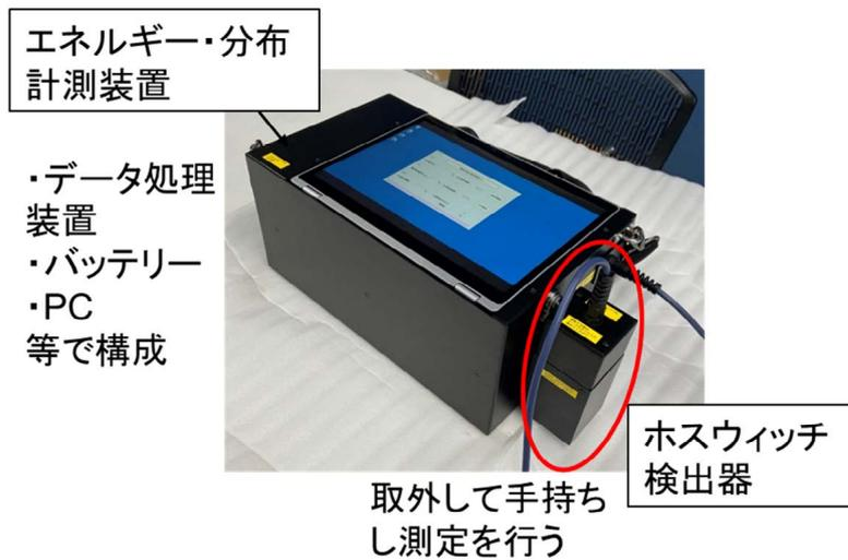
図 3.2.2-1 試作したエネルギー・分布計測装置
