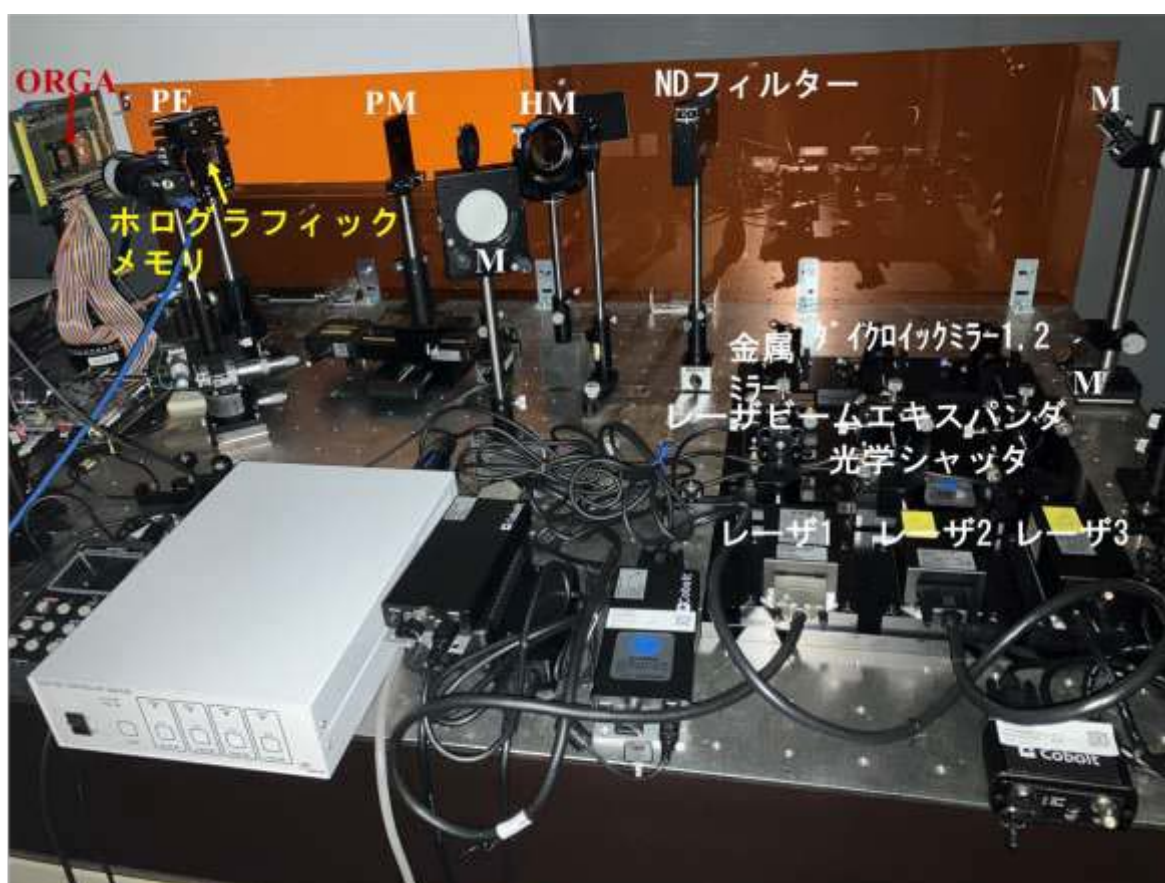
図 3.5.1-3 実際に構築した異なる 3 波長レーザを用いた干渉光学システムの全体写真
