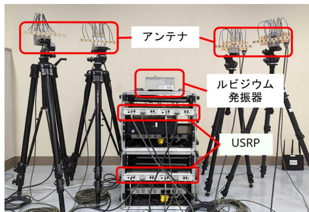
図 3.2.2-2 構築した測定系の外観
