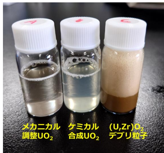
図 3.1-19 UO 2 メカニカル微粒子、UO 2 ケミカル微粒子及び(U, Zr)O 2 デブリ微粒子に対する H 2 O 2 添加効果 (8.5%)
