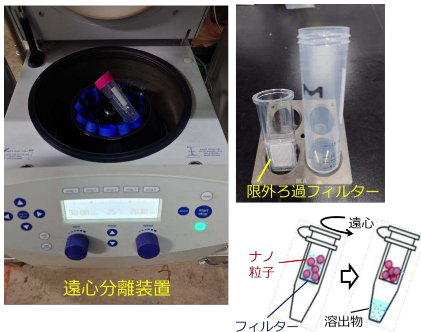
図 3.1-8 遠心分離機を用いたマイクロ限外ろ過法の装置と概念図
