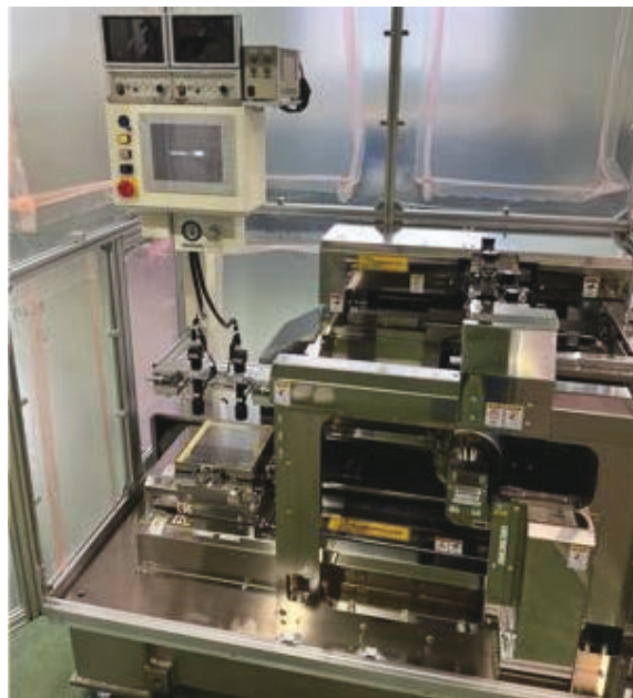
図 3.3-5 スクリーンオフセット印刷機 (センサー実装に向けて整備を進めている。)
