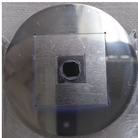
図 3.1-2 2 インチサイズの試料ホルダー
