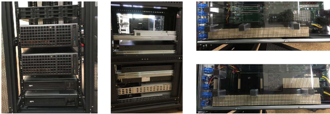
図 3.3-9 構築した GPU サーバ環境（左：正面、中央：側面、右上：H100、右下：A100×2）
