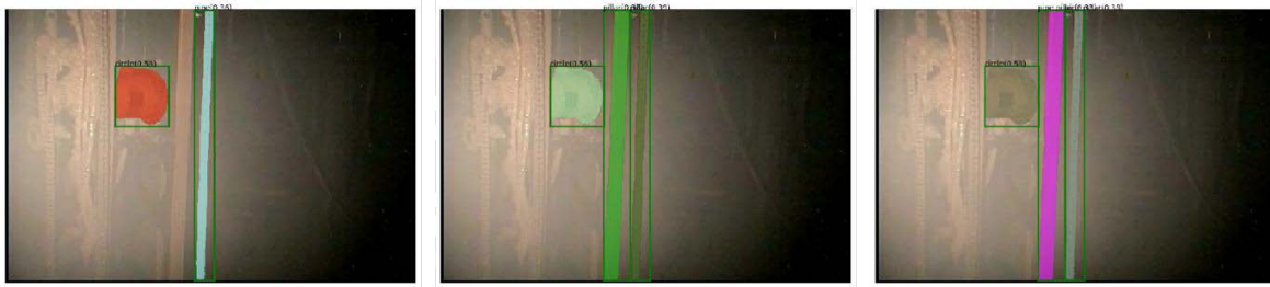
図 3.3-5 FastSAM によるインスタンスセグメンテーション結果（透明度が低下したシーン） （出典：東電 HD）
