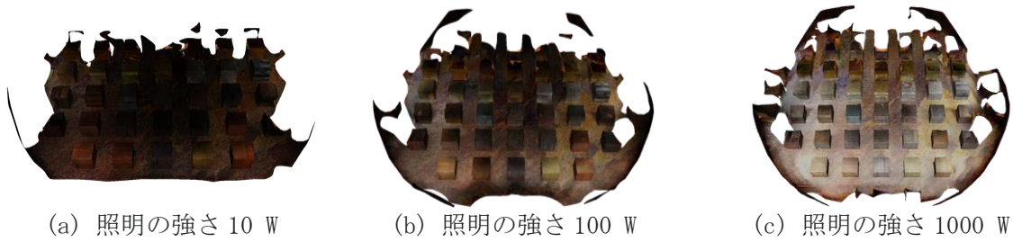
図 3.1-6 各ライティングにおけるカメラの視野角 103 度で撮影した画像による立体復元結果例
