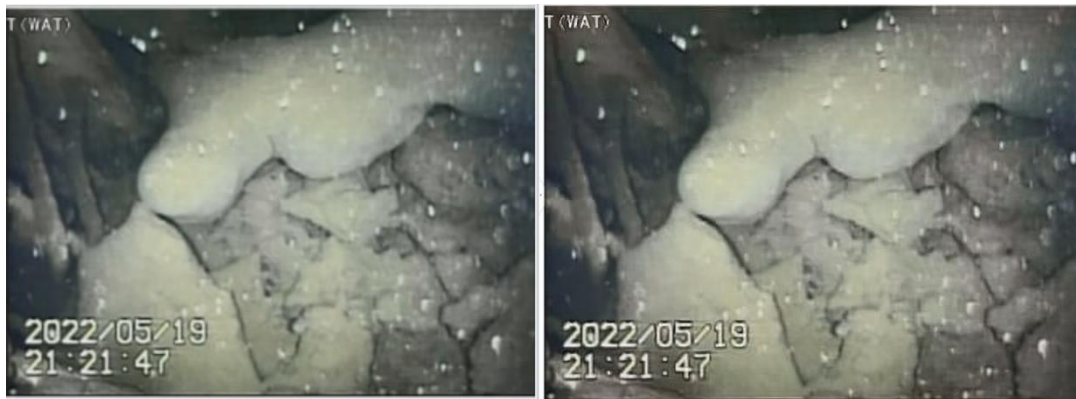
図 3.3-11 DiffBIR による低品質画像の復元結果（左：入力画像、右：出力画像） （出典：東電 HD）
