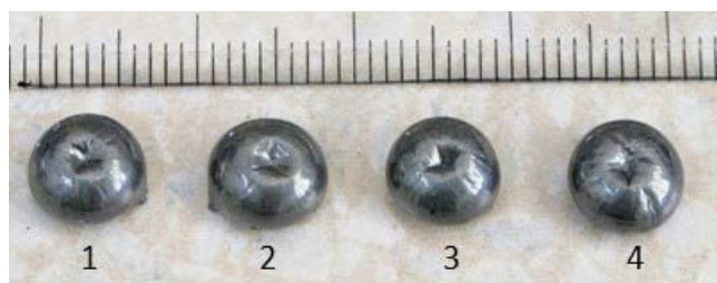
図 3-28 アーク溶解後 U-Zr-O 外観写真（ナンバー1～4）
