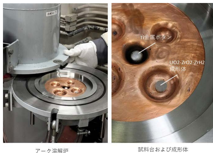
図 3-27 アーク溶解炉外観写真及び ZrO 2 -UO 2 -ZrH 2 加熱前成形体の外観写真
