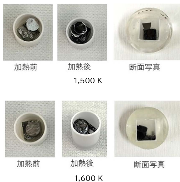
図 3-34 コンクリート・金属 Zr 反応試験 試料外観写真 (加熱前、加熱後及び切断後)
