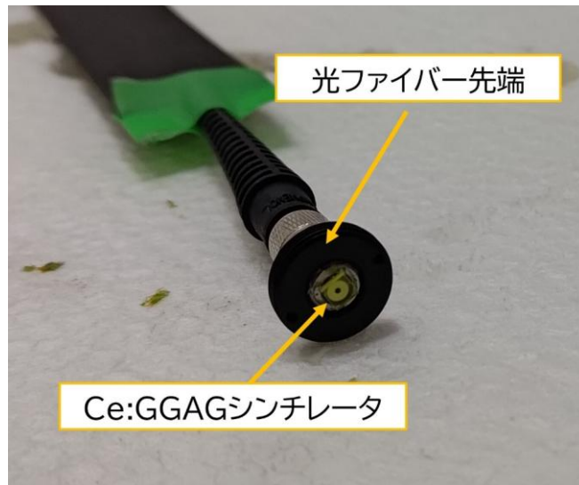
図 3-53 光ファイバー先端に接着した Ce:GGAG シンチレータ
