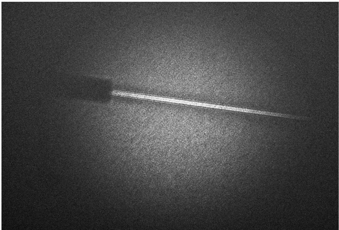
図 3.2-21 エアダスターから噴出するガスのシャドウグラフ（露光時間 5 ミリ秒）
