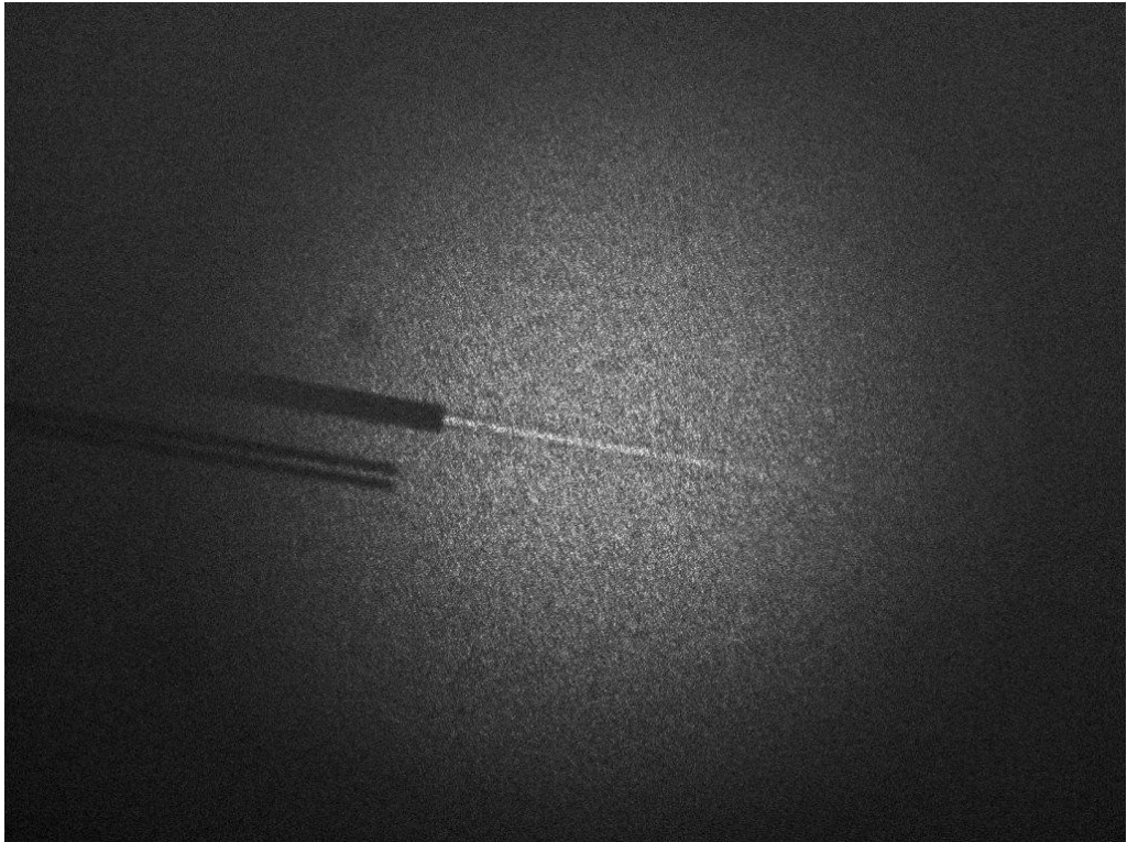
図 3.2-19 エアダスターから噴出するガスのシャドウグラフ（検査面から 20 cm）
