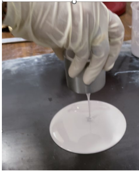
図 3.1-8 ジオポリマーペーストのフローテスト (JASS15M-103)
