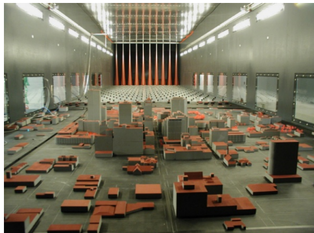
写真 1 ハンブルグ大学拡散風洞実験施設[1]
