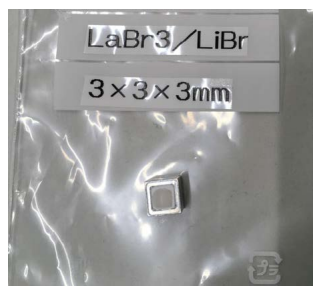
図 3.4-3 寸法が 3 mm×3 mm×3 mm (厚さ) の共晶体 LaBr 3 /LiBr を石英窓付のアルミパッケージで密封したシンチレータ
