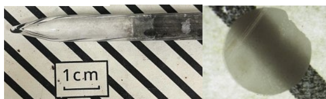
図 3.1-14 Ce, Sr:LaBr 3 / 6 LiBr の育成結晶写真 (左) と 1 mm 厚結晶 (右)
