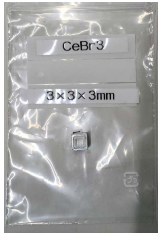
図 3.4-1 寸法が 3\text{ mm} \times 3\text{ mm} \times 3\text{ mm} の \text{CeBr}_3 結晶を石英窓付のアルミパッケージで密封したシンチレータ
