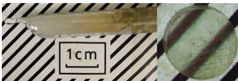
図 3.1-1 育成した \text{Tl}:\text{CsI}/^6\text{LiBr} 結晶（左）と 1 mm 厚結晶（右）
