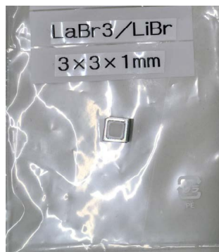
図 3.4-2 寸法が 3\text{ mm} \times 3\text{ mm} \times 1\text{ mm} （厚さ）の共晶体 \text{LaBr}_3/\text{LiBr} を石英窓付のアルミパッケージで密封したシンチレータ
