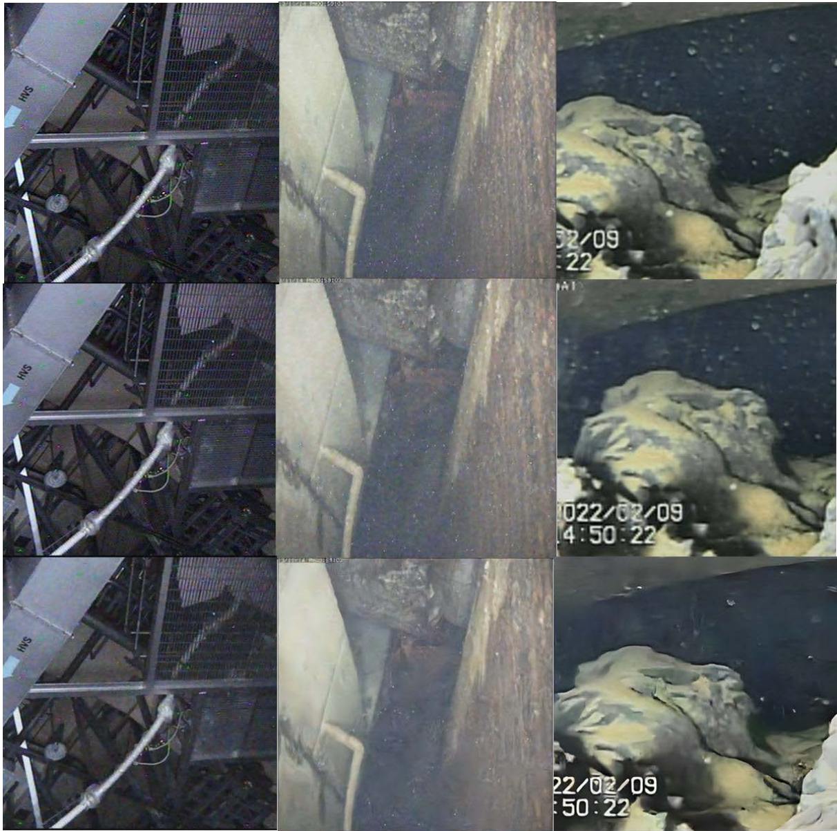
図 3.3.1-2 図 3.3.1-1 の画像へ画像処理を適用した結果 (上段：FSRCNN、中段：RED-Net、下段：Noise2Noise)
