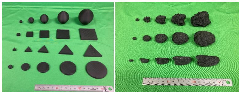
図 3.2.3-15 回収対象 (左図は単純形状、右図は燃料デブリのイメージモデル)
