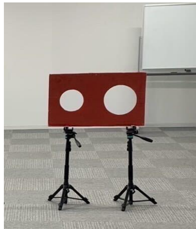
図 3.1.3-5 LIDAR-カメラキャリブレーション用ターゲット
