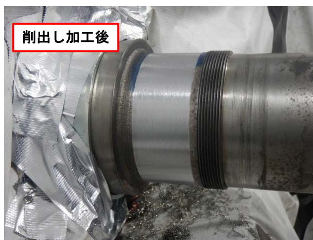
写真5 溶射作業前加工状況
