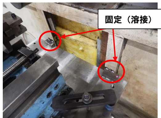
(b) 間座と送風機フレームの固定状況
