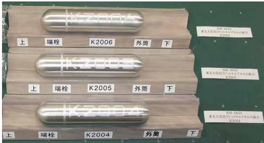
写真 2.4.1-4 東北大ラビットキャプセル完成品
