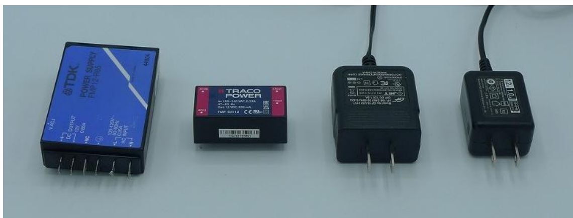
写真 2.11.10-2 現用品及び選定した代替電源の外観
