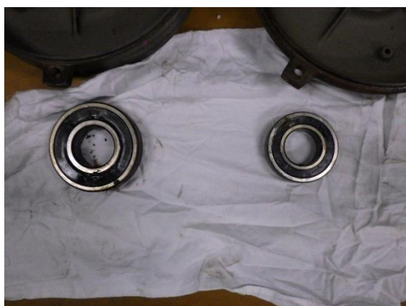
写真 2.2.16-1 摩耗した軸受
