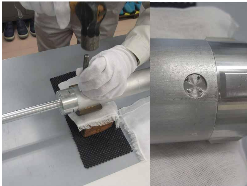
写真 2.4.1-5 外れ止め用ピンカシメ作業
