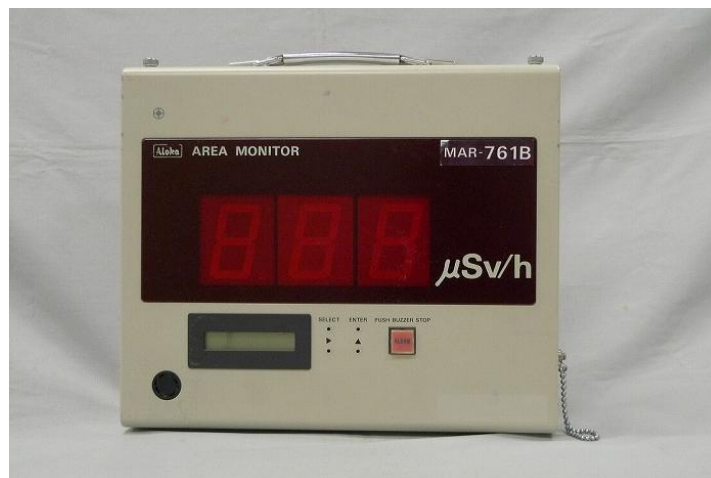
写真 2.11.10-1 可搬型エリアモニタ
