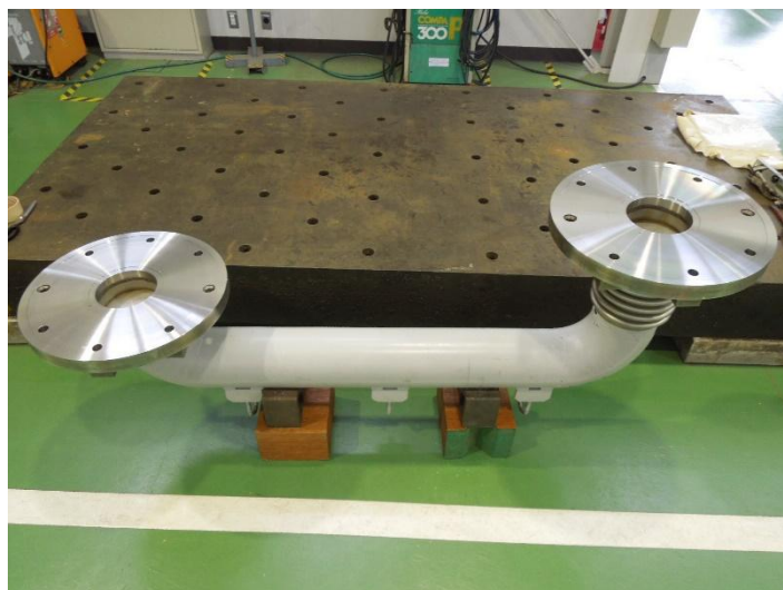
写真 2.11.11-1 フランジ付配管のモックアップ
