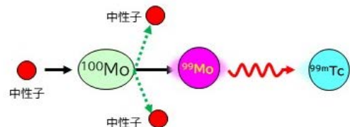
図 2-3 ^{99}\text{Mo} 製造のための主な反応
