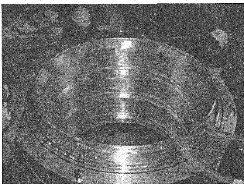
図5 内部シールド取り付け作業
