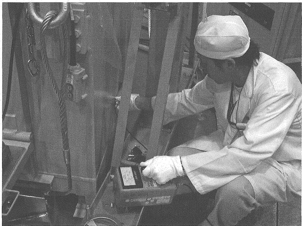
写真 5.3-4 保管容器側面線量測定
