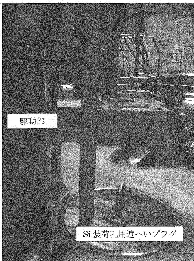
写真 3.1-4 Si 装荷孔と駆動部の隙間の関係
