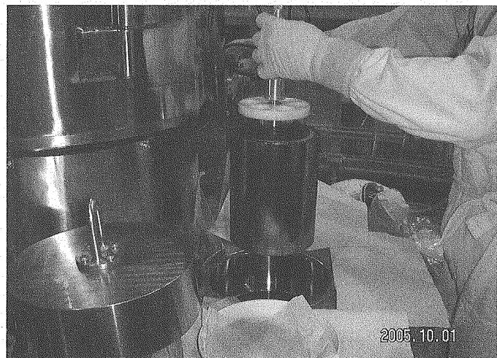
写真 3.1-2 吸着装置による照射用 Si の出し入れ作業
