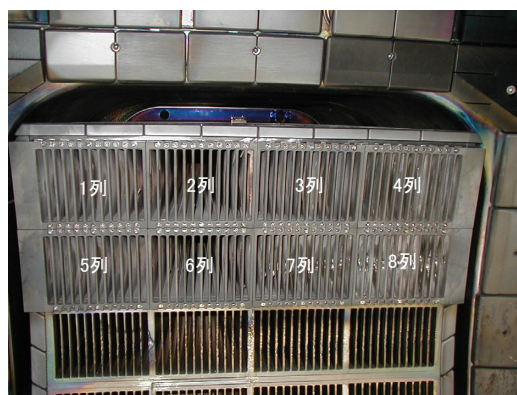
図 4-3 運転終了直後の耐熱化アンテナ
