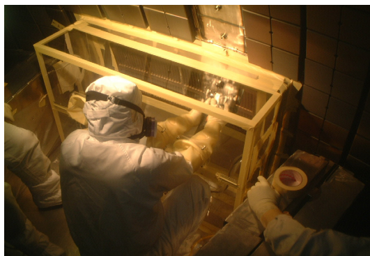
図 2-2 LH アンテナ先端部の補修
