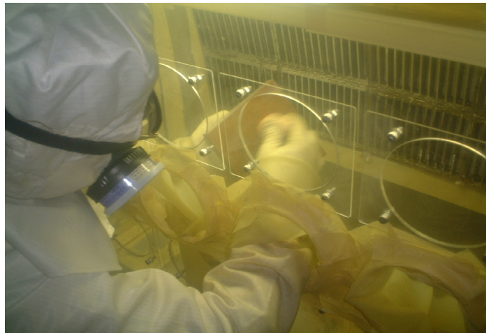
図 23 検査材（新明丹）によるすりあわせ作業
