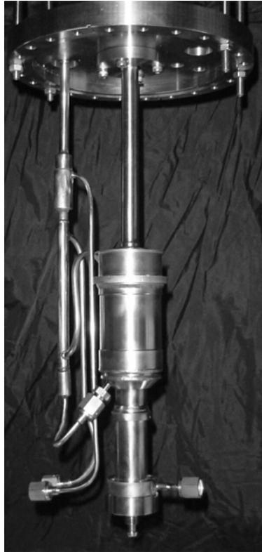
図4 スクリュー式ペレット生成器の外観
