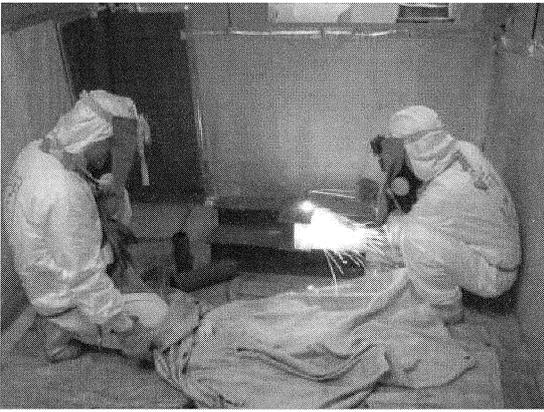
Fig.6-8 ガス切断機を使用した模擬廃棄物の切断状況
