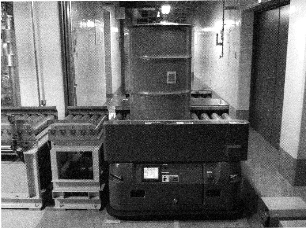
Fig.6-1 高圧圧縮装置とのドラム缶の取り合い
