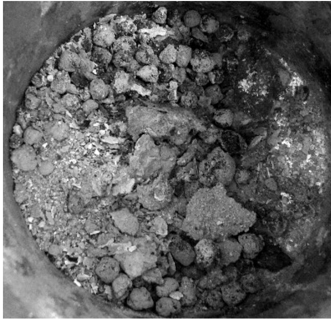
図 3.1 残渣受け容器に排出された残渣
