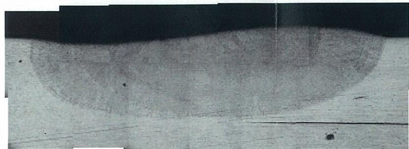
写真 3-8 溶け込み状態（実機 S : 0.001wt%）
