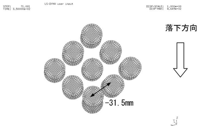
図 5.2-13 コーナー落下時の変形後の内容器蓋部および底部の配置
