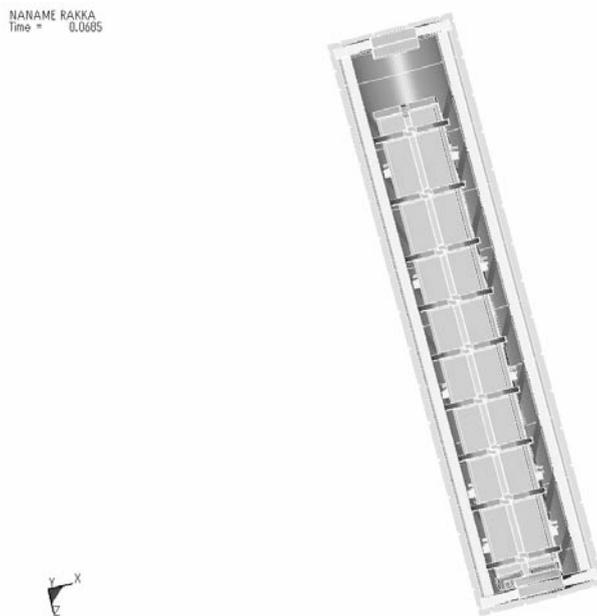
図 6.2-19 コーナー落下時の輸送容器の変形挙動
