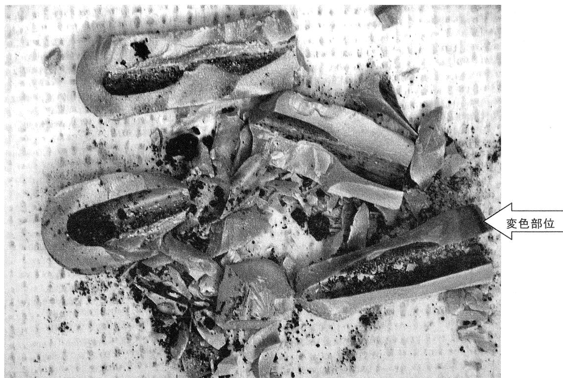
Fig. 5.12 酸化鉄型センサーNo.3 のジルコニア隔膜をハンマーで破壊
