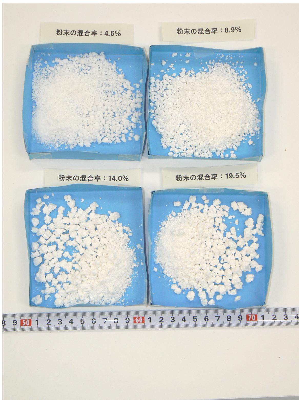
Photo. 3  $\text{SrSO}_4$  と  $\text{TiO}_2$  の両粉末の固化体
