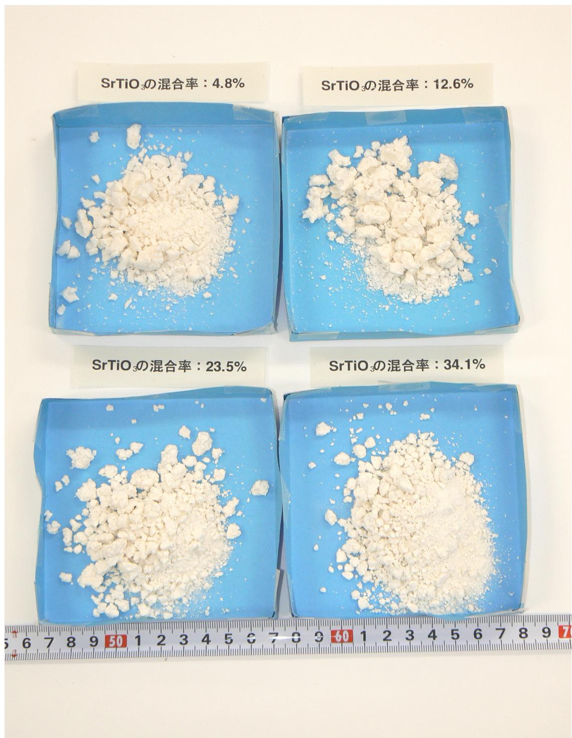
Photo. 1 SrTiO<sub>3</sub>の固化体
