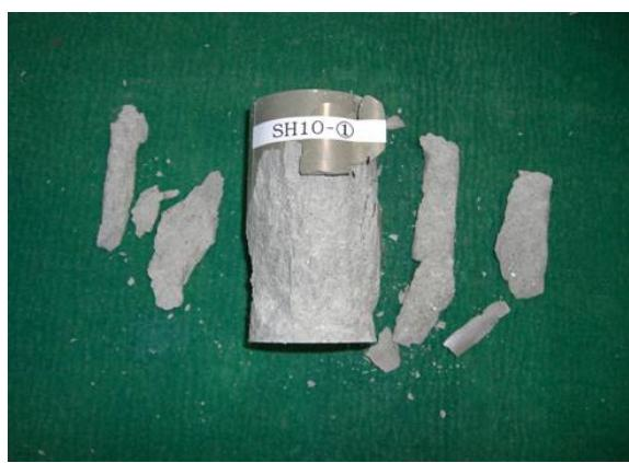
模擬硝酸塩廃液含有率 10wt%
