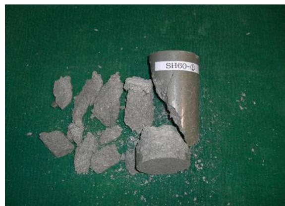
模擬硝酸塩廃液含有率 60wt%
