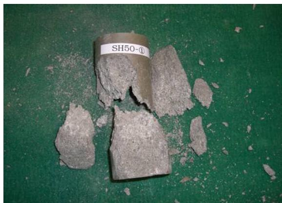
模擬硝酸塩廃液含有率 50wt%
