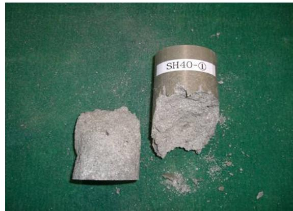
模擬硝酸塩廃液含有率 40wt%
