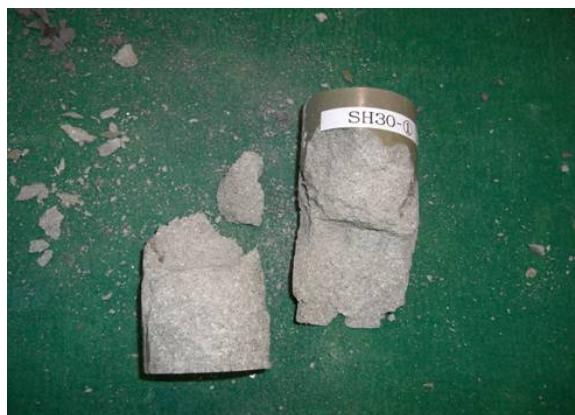
模擬硝酸塩廃液含有率 30wt%
