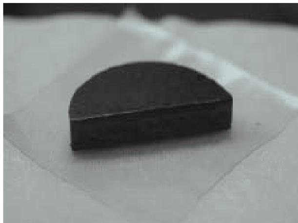
(C) グローブボックス内で成型した後の供試体
