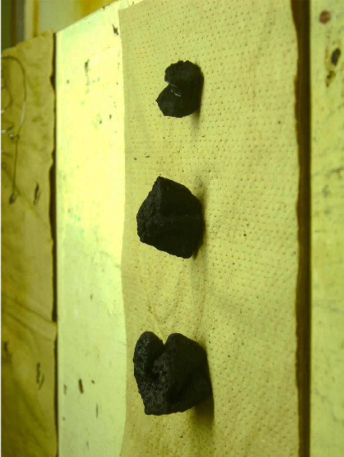
写真3.4 アスファルト固化体(LA)の浸出試験3の試験終了後の外観写真
