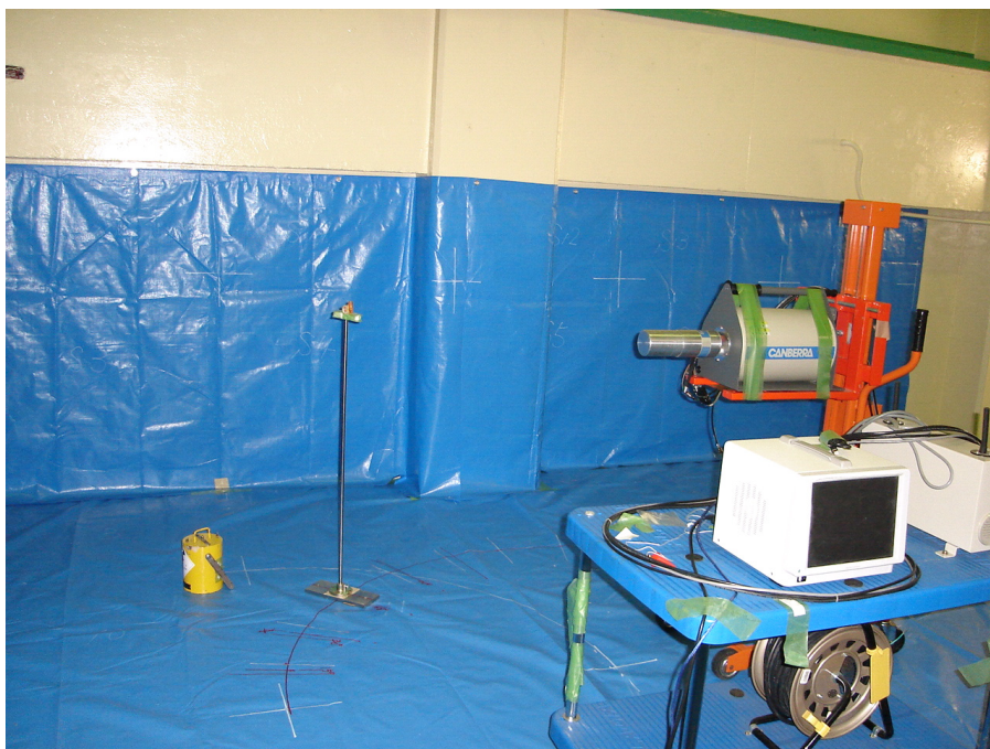
写真 2.1 方向特性試験状況（線源位置角度 45^\circ ）
