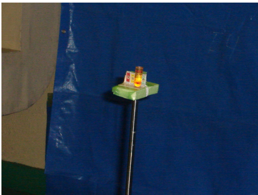
写真 2.2 方向特性試験状況（線源設置状況）
