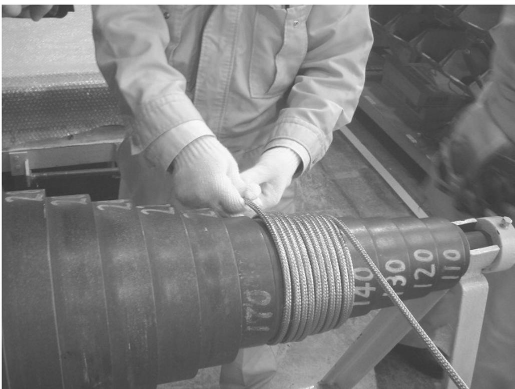
図 26. 最小曲げ半径屈曲状況（高電圧用同軸ケーブル 30MGy）
