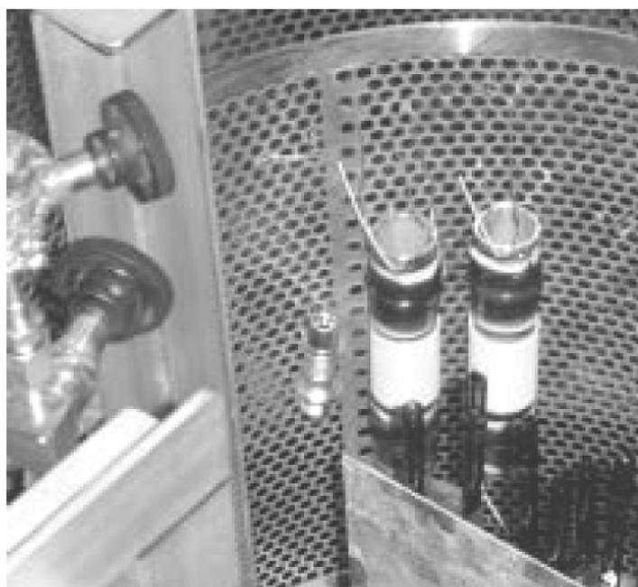
図 16. PEEK ケーブル素線サンプル1 (ガンマ線照射前)
