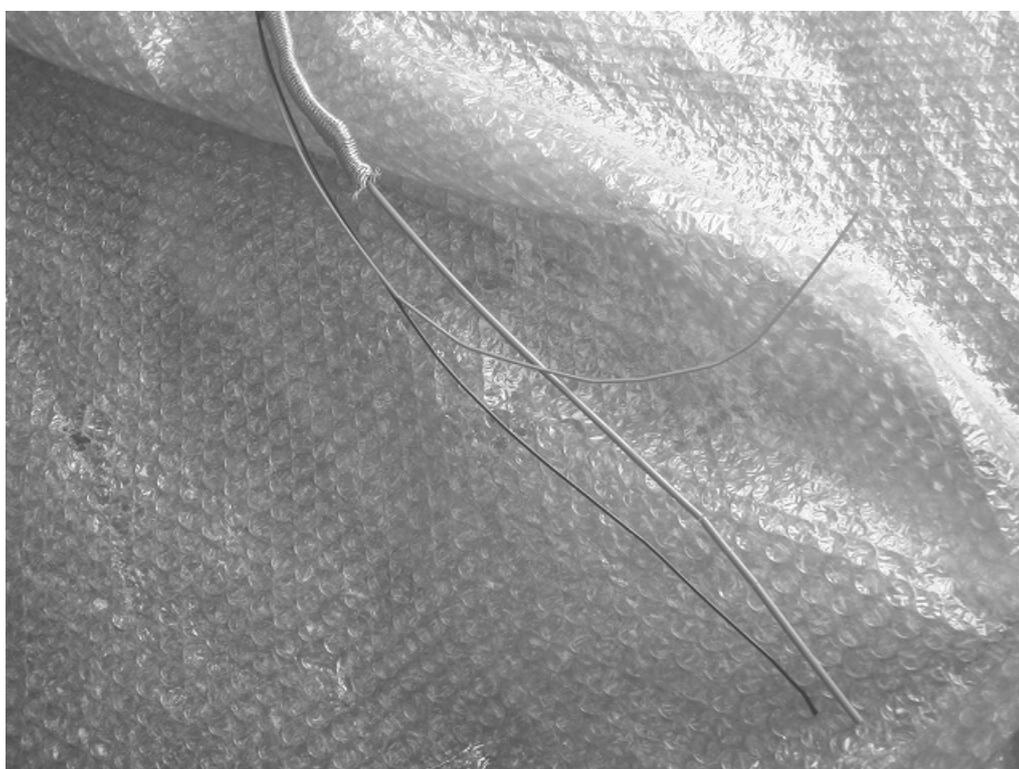
図 27. PEEK 絶縁体の状況（高電圧用同軸ケーブル、30MGy）
