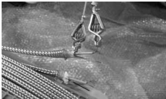
測定結果 : 中心線心と遮へい層間で、500V 印加で測定
