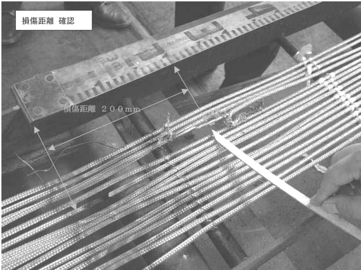
図 31 (3/4). 耐延焼性試験状況 (低電圧動力用ケーブル) 30MG y
