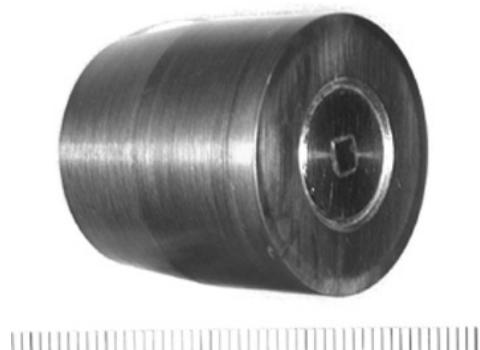
Fig. 2.5 金属試料ホルダー
