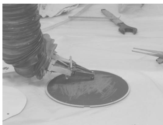
Fig. 3.17 TEM 試験片の切断後のバリ除去作業
